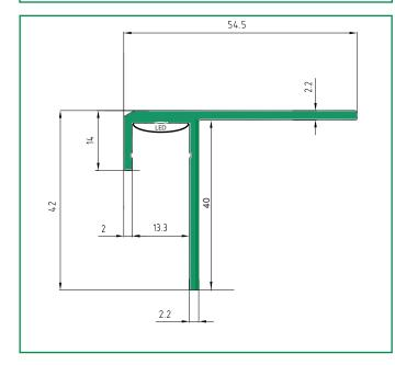
Ein in die Profilnase versteckt eingeklebtes RGB-LED-Band leuchtet das Profil an und sorgt somit für den besonderen Auftritt auf den Messestand.
